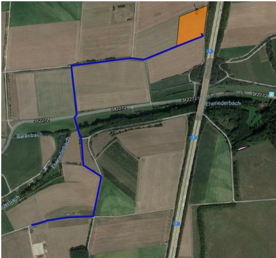
*Abbildung 4: Trasse zur Einspeisung ins Stromnetz zwischen geplanter PV Anlagen und Einspeisungsstelle von Nord nach Süd*
